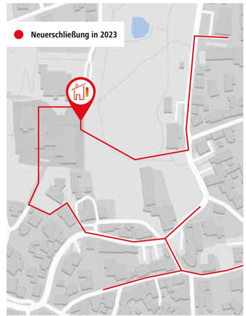
In der ersten Ausbaustufe entstehen 1,1 Kilometer Wärmeleitungen, um den Ortskern von der zentralen Heizanlage aus mit Nahwärme zu versorgen.
